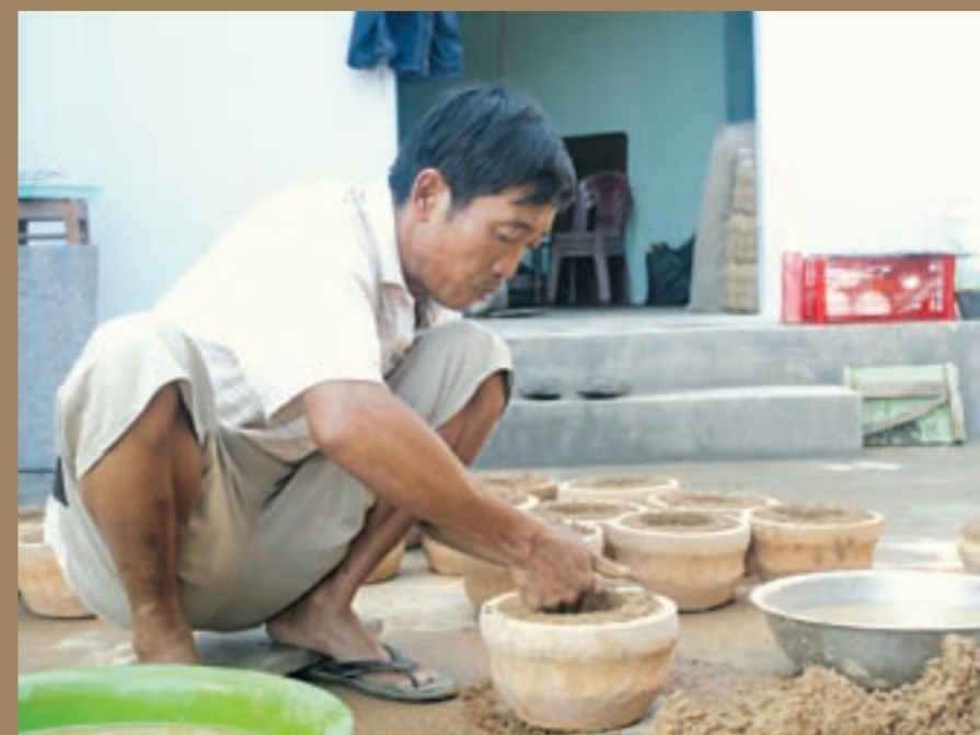
● Công đoạn tạo khuôn đúc đồng ở làng nghề đúc đồng Phú Lộc (Diên Khánh).
